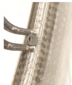
La valvola in silicone è incisa per consentire lo scarico delle perdite d'aria interne
