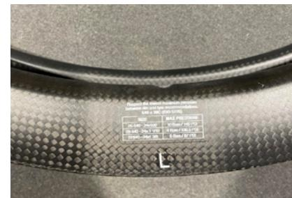
Zur Unterscheidung sind sie mit einem R (rechts) und einem L (links) gekennzeichnet.
