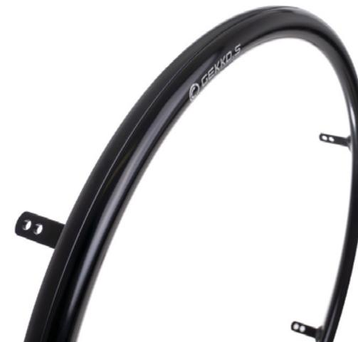
Exemple de main courante de la marque Carbolife avec le standard 6 tab mounts.
